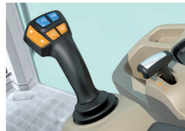
Kabina w wersji Essential w modelu MF 5700 S z elektronicznym joystickiem wielofunkcyjnym do sterowania ładowaczem
