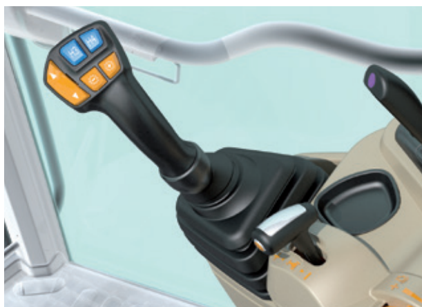
Kabina w wersji Essential z mechanicznym joystickiem wielofunkcyjnym
