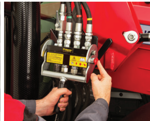
Odłącz złącza hydrauliczne i elektryczne
