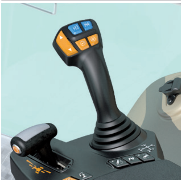
Kabina w wersji Efficient z elektronicznym joystickiem wielofunkcyjnym i podłokietnikiem
