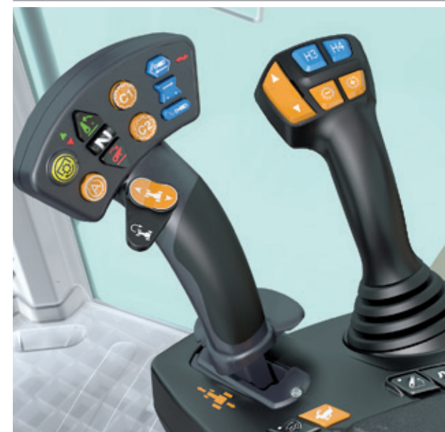
Kabina w wersji Exclusive z dźwignią Multipad i elektronicznym joystickiem wielofunkcyjnym (z prawej)
